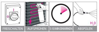
Anlage freischalten und elektrische Leitungen schützen. Reiniger mit einem Niederdrucksprühgerät in den Wärmetauscher sprühen. Die Anwendung in einer der oberen Ecken beginnen und systematisch seitlich und nach unten fortsetzen. 5-10 Minuten einwirken lassen. Anschließend mit klarem Wasser abspülen.
