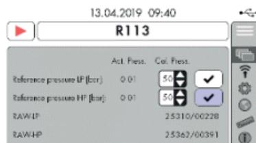
Aspettate che la pressione di calibrazione conforme alla pressione di riferimento. Premendo  si calibra il singolo sensore di pressione.
