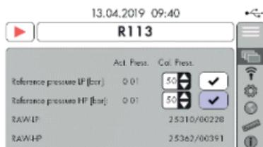
Espera hasta que la presión de calibración corresponde al presión de referencia. Pulsando
