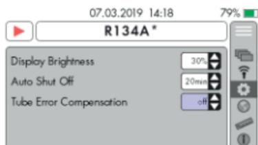
La compensazione dell'errore di misura sul tubo è una funzione di correzione della temperatura che compensa l'errore di misurazione tra tubo e refrigerante.
