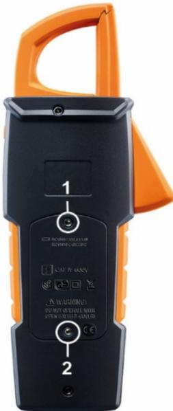
2. Die beiden Metallschrauben (1, 2) am Batteriefach mit einem Schraubendreher so weit lösen, bis sich der Batteriefachdeckel abnehmen lässt. Die Schrauben nicht vollständig herausdrehen.
