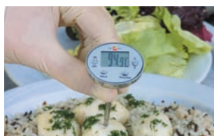
Für Temperaturstichproben-Messungen in der Lebensmittelproduktion.
