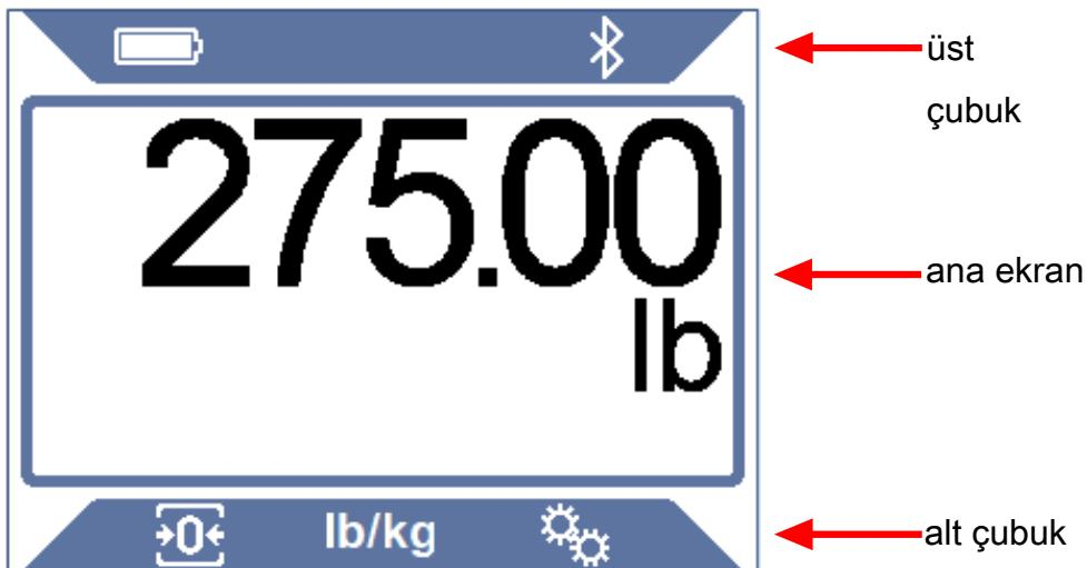
**Üst çubuk:** Üst çubuk, pil simbolü ve Bluetooth durumunu içerir.
