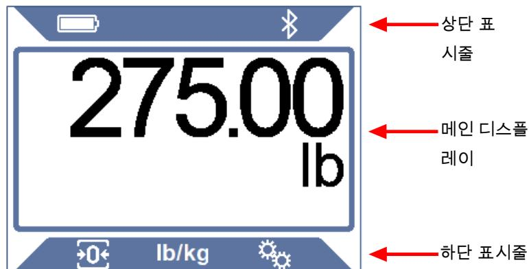
**상단 표시줄:** 상단 표시줄에는 배터리 기호와 Bluetooth 상태가 표시됩니다.
