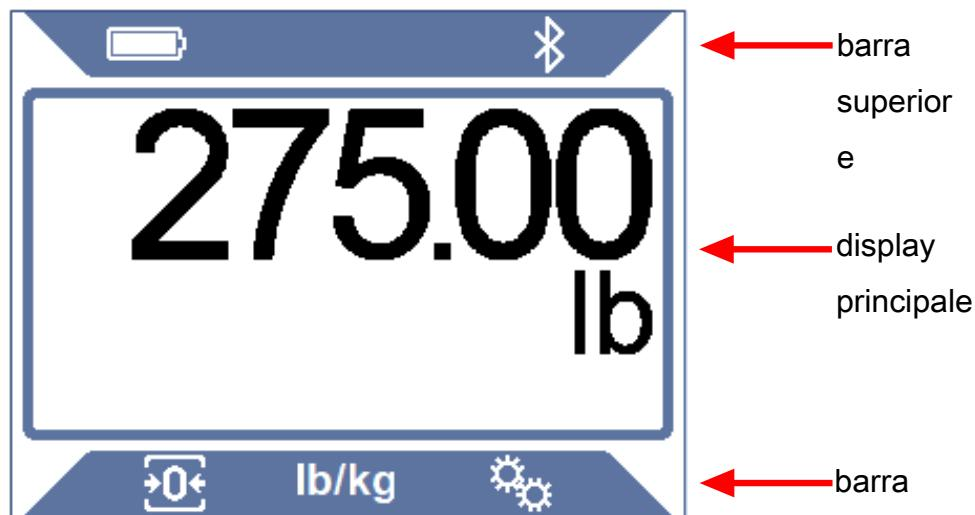
**Barra superiore:** la barra superiore include il simbolo della batteria e lo stato del Bluetooth.
