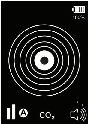
Abb. 10: Alarmanzeige (im Automatikmodus – Audio EIN)
