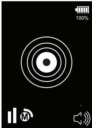
Abb. 28: Handmodus-Reset-Symbol blinkt synchron mit Resettastendruck
