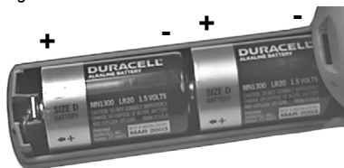
Figura 7 Batterie alcaline installate correttamente
