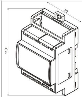
Das Modul ist für die Montage auf Hutschiene (vier standard DIN-Module) im Schaltkasten geeignet.
