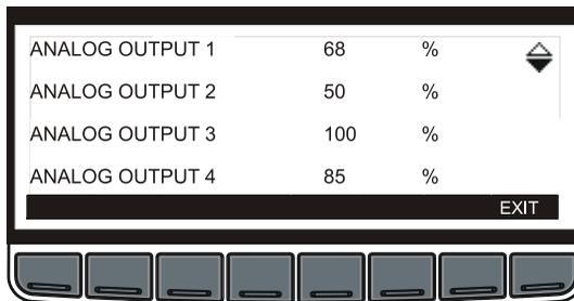
Die Analogausgänge können verwendet werden, um einen externen Inverter zu steuern oder um den Wert des Hauptfühlers über ein 4-20mA oder 0-10V Signal weiterzugeben.
