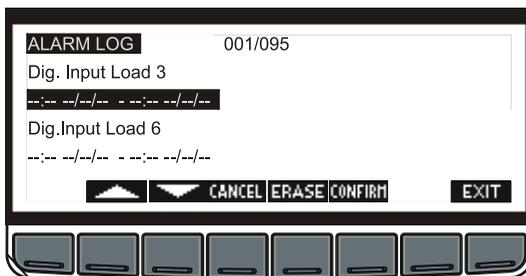
Um den Vorgang zu bestätigen und alle gespeicherten Alarme zu löschen, **CONFIRM**-Taste drücken.
