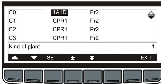
Set-Taste **SET** drücken und zum Ändern des Wertes die Pfeiltasten verwenden.
