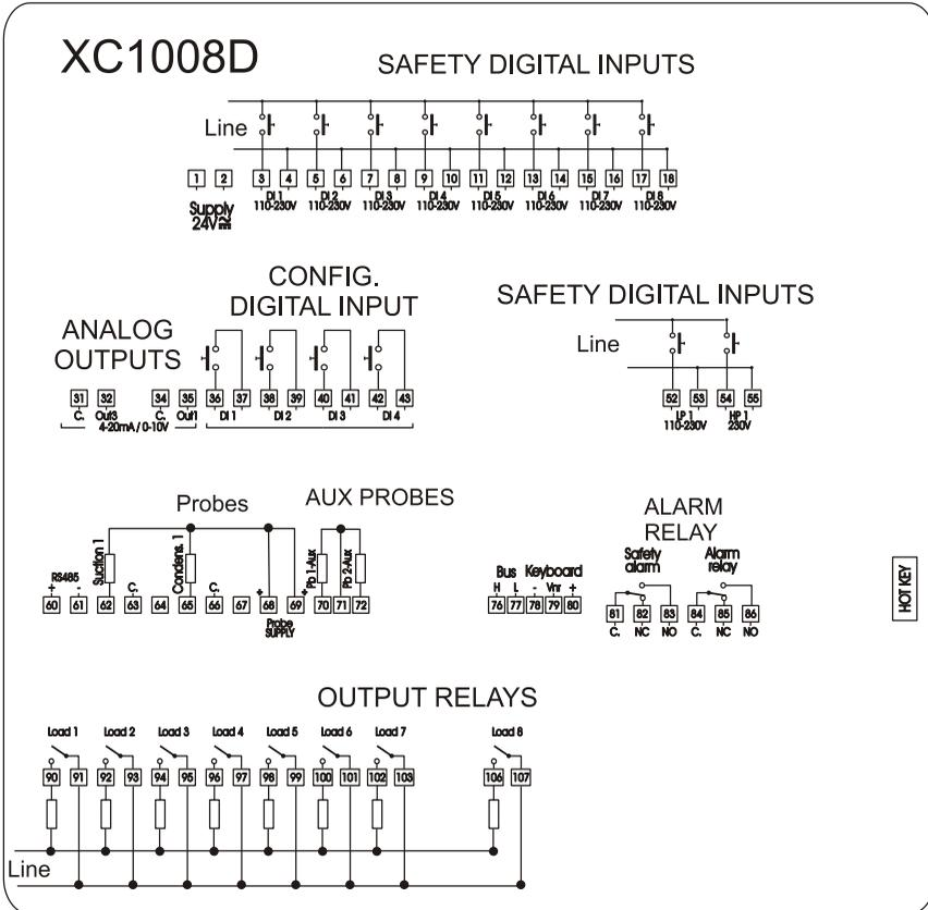
**ANMERKUNG:** Je nach Modell können die **Digitaleingänge** 3-18 und 52-55 können mit 230V/120V oder 24V arbeiten. Bitte am Gerät prüfen, welche Spannung verwendet werden kann.
