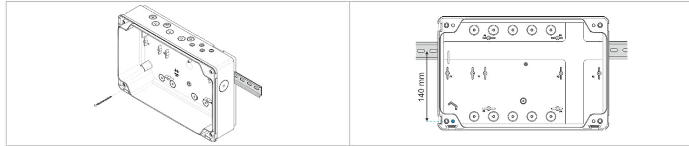
XER kann auf einer DIN-Schiene montiert und mit 1 Schraube befestigt werden (Typ: D 4,5 mm x L 55 mm)
