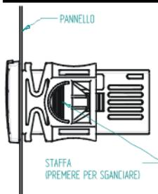
Die Tafleinbau-Geräte XR72CX sind für einen Ausschnitt 71x29 mm vorgesehen und werden mit zwei Befestigungsbügel fixiert. Die Befestigungsbügel von hinten aufschieben und durchschieben bis beide Bügel fest einrasten.
