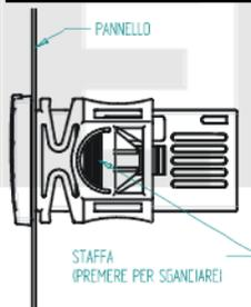
Die Tafelbau-Geräte XR70C sind für einen Ausschnitt 71x29 mm vorgesehen und werden mit zwei Befestigungsbügel fixiert. Die Befestigungsbügel von hinten aufschieben und durchschieben bis beide Bügel fest einrasten.
