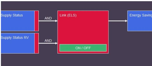
Die für die einzelnen Eingänge konfigurierte Logik wird auf dem Projektbildschirm als Beschriftung an denselben Eingängen angezeigt. Wie in der obigen Abbildung dargestellt.
