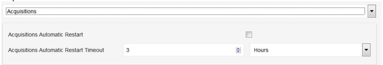
XWEB kann so konfiguriert werden, dass es die Erfassungen nach einer bestimmten Zeit ab dem Zeitpunkt, an dem die Erfassungen gestoppt wurden, automatisch startet.
