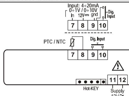
Fühler: Pt100= 7 – 9 (8); Thermoel. J, K, S = 7(+); 9(-); 12Vac/dc od. 24Vac/cd Hilfsenergie: 11-12
