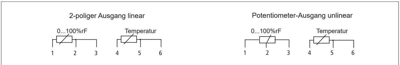
**Anschlussplan für aktive Sensoren UB=15...30V DC**
