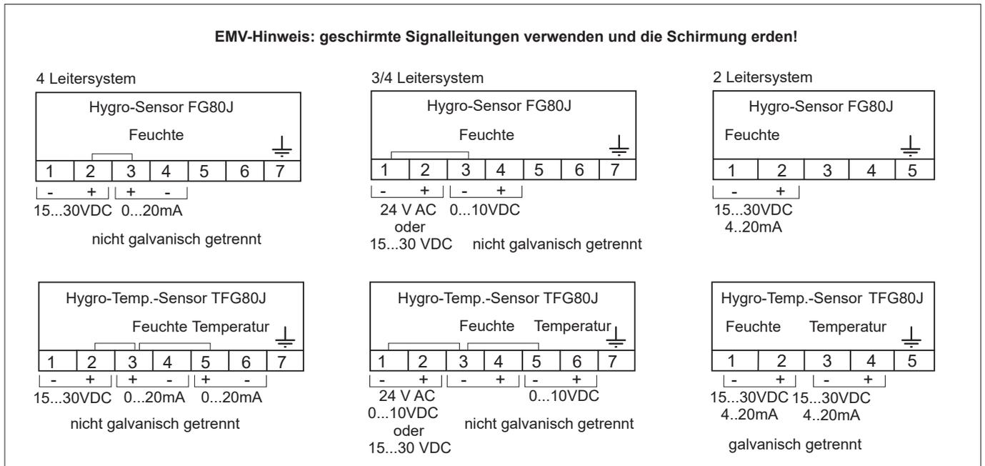
**Anschlussplan für aktive Sensoren UB=24V AC (±10 %)**
