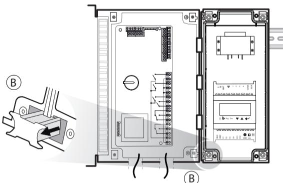
4: Das Modul an das UltraCella-Steuergerät anreihen. Die beiliegenden Verbindungshalterungen einsetzen (B).
