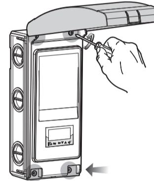
3: Den Deckel anheben oder die Blenden abnehmen und die Schrauben lösen, um das Frontteil zu entfernen und das Modul zu öffnen.
