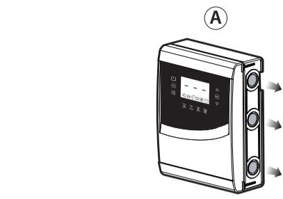
2: Enlever les cadres (1 et 2). Enlever les vis (3) et ouvrir le contrôle UltraCella.
