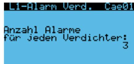
Die Anzahl der Alarmer pro Verdichter ist für alle Verdichter derselben Leitung dieselbe.
