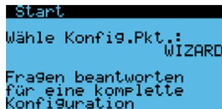
Mit dieser Lösung wird die für die eigene Anlage empfohlene Konfiguration eingestellt. Der Benutzer wird anhand einer Reihe von Fragen zur Wahl der Vorrichtungen von einer Maske zur nächsten geleitet.
