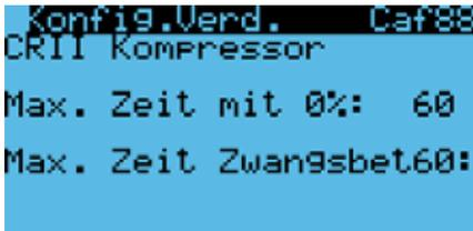
CR11 unloader delay - Aktivierungsverzögerung einer Teillast.
