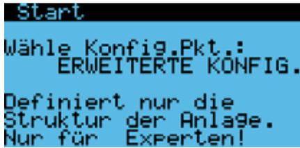
Diese Lösung lässt die für den korrekten Anlagenbetrieb nötige pLAN-Netzwerkstruktur konfigurieren. Nach Abschluss des Wahlverfahrens aller Endkonfigurationsfaktoren überprüft die pRack pR300-Software, ob die pLAN-Konfiguration korrekt ist. Sie bereitet die Benutzerschnittstelle für die Parameterkonfiguration vor (die vom Benutzer manuell auszuführen ist).
