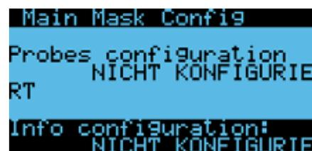
In dieser Maske kann gewählt werden, ob die Fühlerdaten oder die untere Leiste mit den Prozentsätzen und den pro Kreislauf aktiven Peripherien konfiguriert werden sollen.
