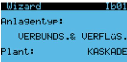
Nach der Wahl dieser Konfiguration braucht die Software einige Sekunden, um einige Voreinstellungen für eine Kaskadenanlage zu tätigen. Für die zweite Verflüssigungsleitung wird gefragt, ob der CO<sub>2</sub>-Verflüssiger über die Ventilatoren oder über das neue EVS-System geregelt werden soll:
