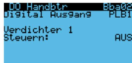
Der Ausgangsfunktionstest lässt die Ausgänge aktivieren oder deaktivieren (dabei kann eventuell ein Ausgangsprozentsatz für die analogen Ausgänge eingestellt werden), ohne die Schutzfunktionen zu beachten.
