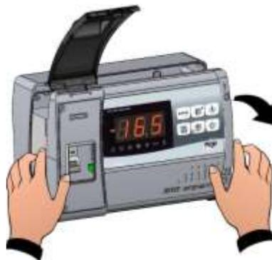
**Abb. 5:** Üben Sie einen Druck auf jede der einzelnen Scharniere aus, um sie aus ihrem Sitz zu lösen und entfernen Sie die gesamte Front.
