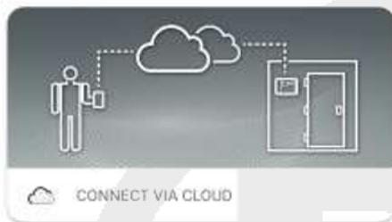
Cloud-Verbindung: Überwachung des Status aller im Abonnementplan registrierten Geräte; Lesen von Parametern und Tagesverlauf; Empfang von Alarmbenachrichtigungen in Echtzeit von allen registrierten Geräten.
