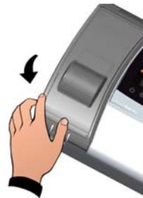
**Abb. 4:** Die Vorderseite des Kastens öffnen, anheben und die beiden Scharniere bis zum Anschlag gleiten lassen.
