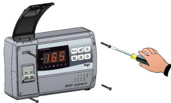
**Abb. 3:** Die durchsichtige Abdeckung des Schutzschalters wieder anbringen.
