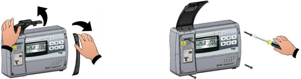
2. Die ECP Steuerung an den in der Innenseite des Gehäuseunterteils vorgesehenen drei Befestigungslöchern befestigen. Danach das Gerät wie auf dem Schaltbild angegeben anschließen. Gehäuseoberteil danach montieren und ECP Steuerung in Betrieb nehmen.
