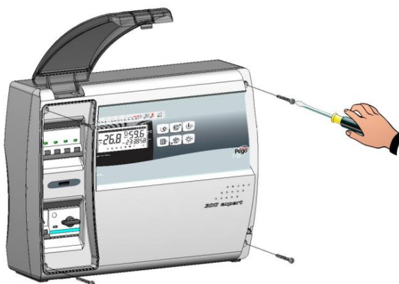
Fig. 2: Die 4 Befestigungsschrauben des Vorderteils des Schaltkastens abschrauben.
