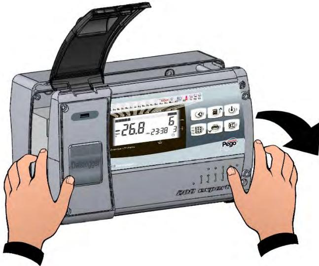
**Abb. 3:** Öffnen Sie die Vorderseite des Gehäuses durch Anheben und Herausziehen der beiden Kunststoffscharniere. Drehen Sie die Front des Gehäuses um 180° nach unten. Sie erhalten jetzt Zugang zum Inneren des Gerätes.
