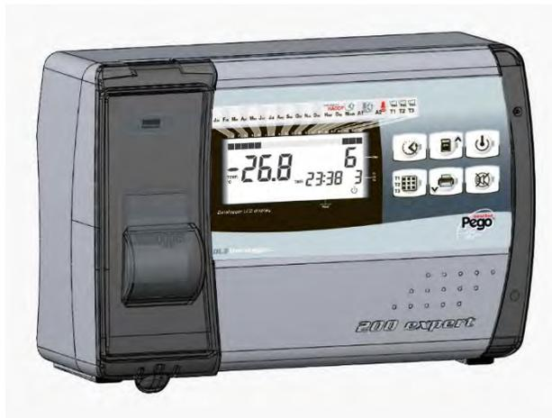
**Abb. 5:** Schließen Sie die Frontplatte und stellen Sie sicher, dass alle Leitungen im Inneren des Gehäuses sind und die Dichtung richtig eingesetzt ist. Befestigen Sie die Frontplatte mit den 4 dafür vorgesehenen Schrauben. Schalten Sie das Panel mit der Stand-by Taste an der Bedieneinheit ein und führen Sie die Ablesung / Programmierung aller erforderlichen Parameter durch.
