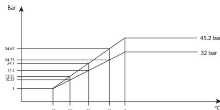
Max. zul. Betriebsüberdruck in bar im Verhältnis zur Medientemperatur in °C
