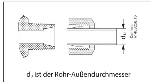
$d_u$  ist der Rohr-Außendurchmesser
