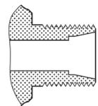
Schneidring, DIN 3861 & DIN 3901 Klasse L,  $d_u = 6$  mm
