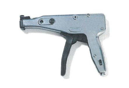
2) Auf der Kabelbinderzange mit Federwaage (Code CM00000006) das Drehmoment 250 N einstellen (Position 6 auf der Zange).
