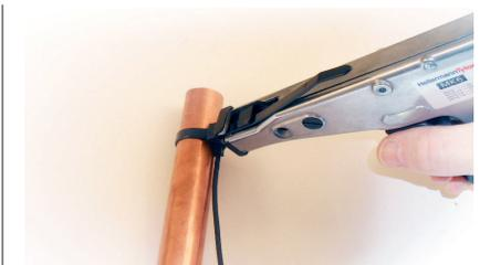
3) Den Kabelbinder mit der Zange so lange festziehen, bis der Kabelbinder abgeschnitten ist.
