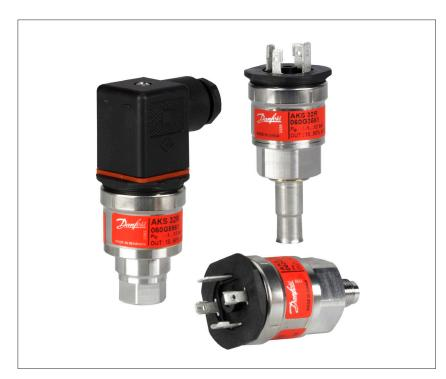
AKS 32R ist ein ratiometrischer Druckmeßumformer, der den gemessenen Druck in ein lineares Ausgangssignal umwandelt. DerMindestwert des Ausgangssignals beträgt weniger als 10% der aktuellen Versorgungsspannung.
