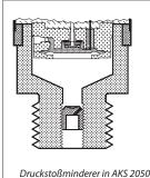
Kavitation, Flüssigkeitsschlag und Druckspitzen können in flüssigkeitsgefüllten Systemen auftreten, in denen sich die Durchflussgeschwindigkeit ändert, z.B. bei schnellem Schließen eines Ventils oder Einschalten bzw. Abschalten einer Pumpe. Das Problem kann sowohl auf der Einlass- als auch auf der Auslassseite auftreten, sogar bei verhältnismäßig niedrigen Betriebsdrücken.
