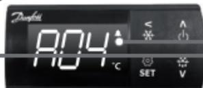
Die Temperatur- und Alarmcodes blinken abwechselnd, bis die Alarmursache behoben wurde. Die Alarmlampe wird angezeigt.
