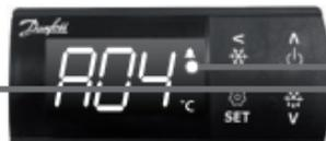
*I codici di temperatura e di allarme lampeggiano alternativamente fino a quando il problema correlato all'allarme non viene risolto.
