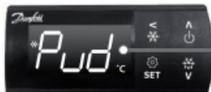
„Pud“: Wird drei Sekunden lang angezeigt und steht für eine Schnellabkühlung. Während der Schnellabkühlung wird das Schnellabkühlungssymbol angezeigt.
