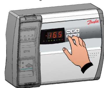
Abb. 20: Schalten Sie den Strom am Bedientableau ein und importieren/konfigurieren Sie alle Parameter.
