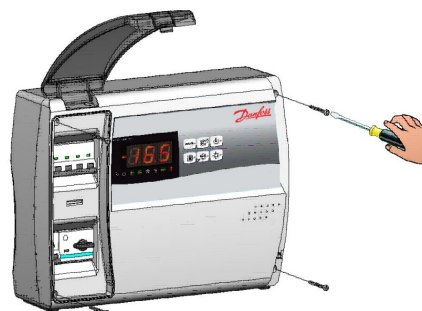
Abb. 19: Die Frontblende mit den vier Schrauben befestigen. Die Schraubenabdeckung auf der rechten Seite wieder anbringen.
