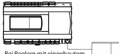
Bei Reglern mit eingebautem Display kann nur noch ein weiteres, externes Display angeschlossen werden.
