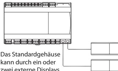
Das Standardgehäuse kann durch ein oder zwei externe Displays erweitert werden.
