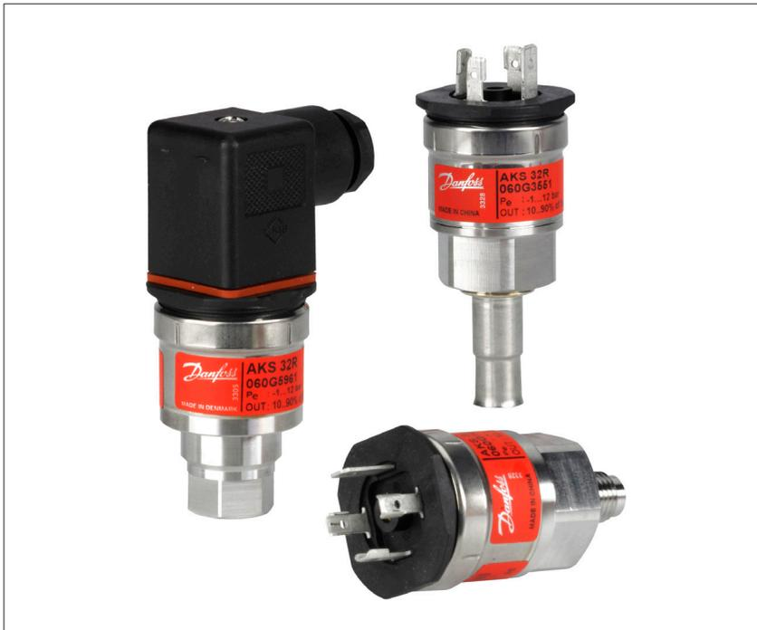
AKS 32R ist ein ratiometrischer Druckmeßumformer, der den gemessenen Druck in ein lineares Ausgangssignal umwandelt. Der Mindestwert des Ausgangssignals beträgt weniger als 10% der aktuellen Versorgungsspannung.
