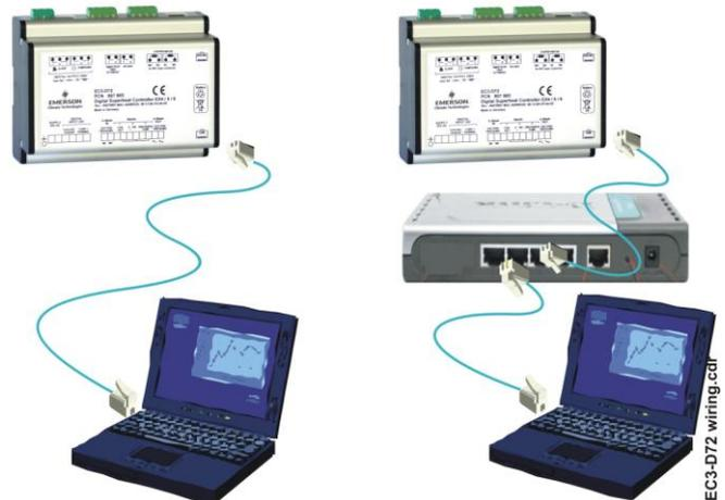
Direktverbindung mit Crossover Kabel
