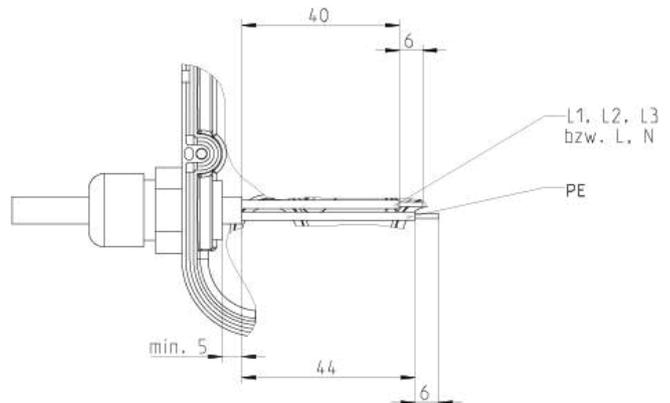
Abb. 1: Empfohlene Abmantelungslängen in mm (innerhalb Klemmkasten)
