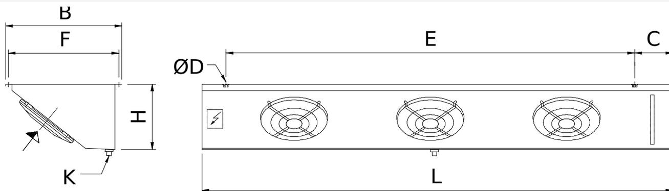
Ablauf nach DIN ISO 228-1 mit G-Gewinde (Flachdichtung).
