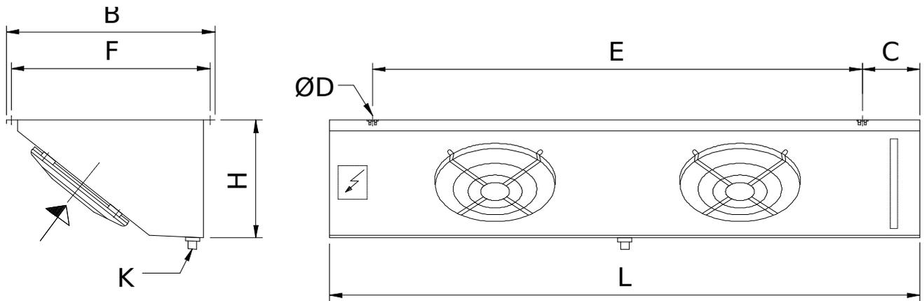
Ablauf nach DIN ISO 228-1 mit G-Gewinde (Flachdichtung).
