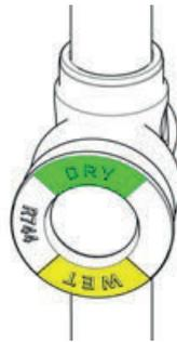
Der Feuchtigkeitsindikator im Flüssigkeitsschauglas muss grün sein, wodurch angezeigt wird, dass keine Feuchtigkeit vorhanden ist.
