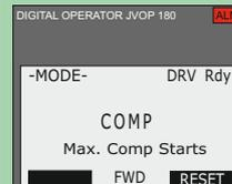
Einer der Verbundverdichter hat die max. Anzahl der möglichen Starts pro Stunde gemäß Einstellung in Parameter P2-05 überschritten. Keine Abschaltung
