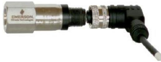
Der Drucktransmitter Alco PT5-30M wird auf der Hochdruckseite des Systems eingesetzt. Drucktransmitter Alco PT5-07M wird auf der Niederdruckseite des Systems eingesetzt. Der PT5 Drucktransmitter wandelt ein Druckeingangssignal in ein lineares elektrisches 4-20 mA Stromsignal um. Dies geschieht mit Hilfe einer piezo-resistiven Messzelle, auf die der Druck über eine Ölfüllung wirkt.
