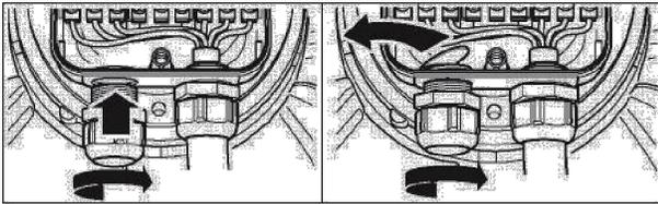
Abb. 4: Durchbruch Kabelverschraubung
